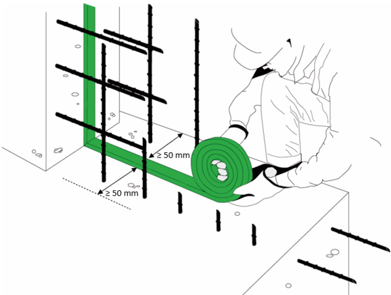
Figure 1 : mise en place du joint – exemple avec joint HYDROSTOP
