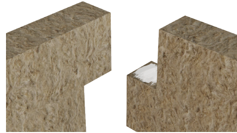
LA FACE HORIZONTALE DE LA JONCTION DES CHICANES DOIT ÊTRE ENCOLLÉE
