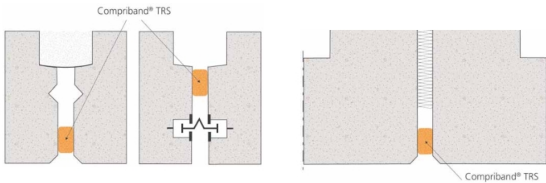
Croquis 21 : En partie verticale d'éléments préfabriqués lourds
